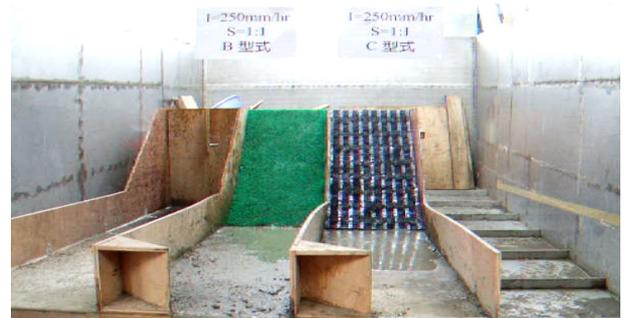
圖 4. T2 與 T3 植生網抗沖蝕試驗示意圖
