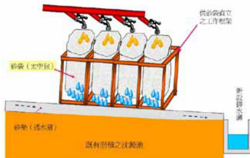
圖 3 以砂袋收集分離水庫抽出的泥水混合物（取材自堅尼士工程顧問公司）
